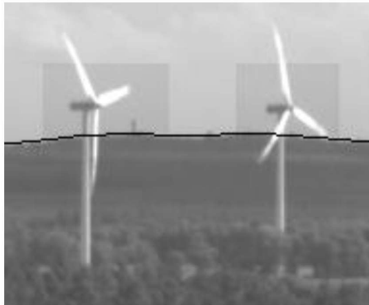
Abbildung 1: Automatisch generierte Ausschlussgebiete um Rotoren von WEA
