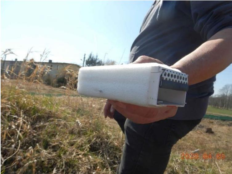
Foto 28: Eidechsenfalle mit automatischem Schließmechanismus
