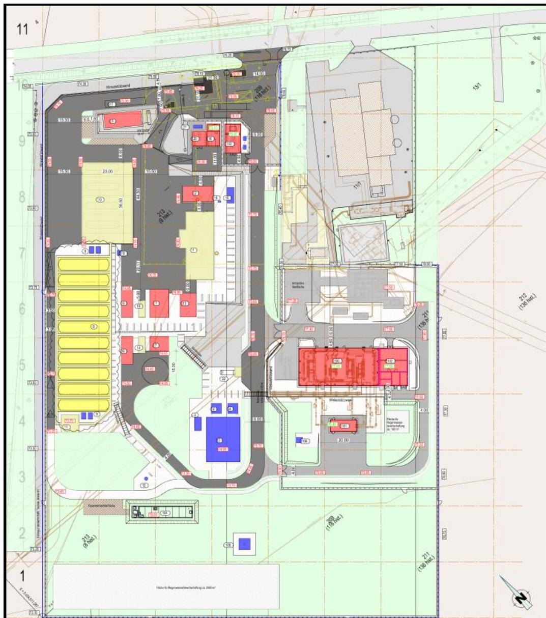
**Abbildung 3-2: Übersichtsplan - LNG-Anlage Blumberg**
