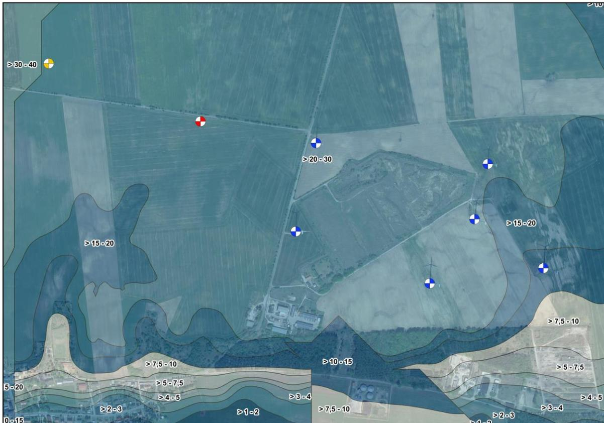
Abbildung 5 Darstellung des Grundwasserflurabstandes im Umfeld der geplanten WEA (rot)
