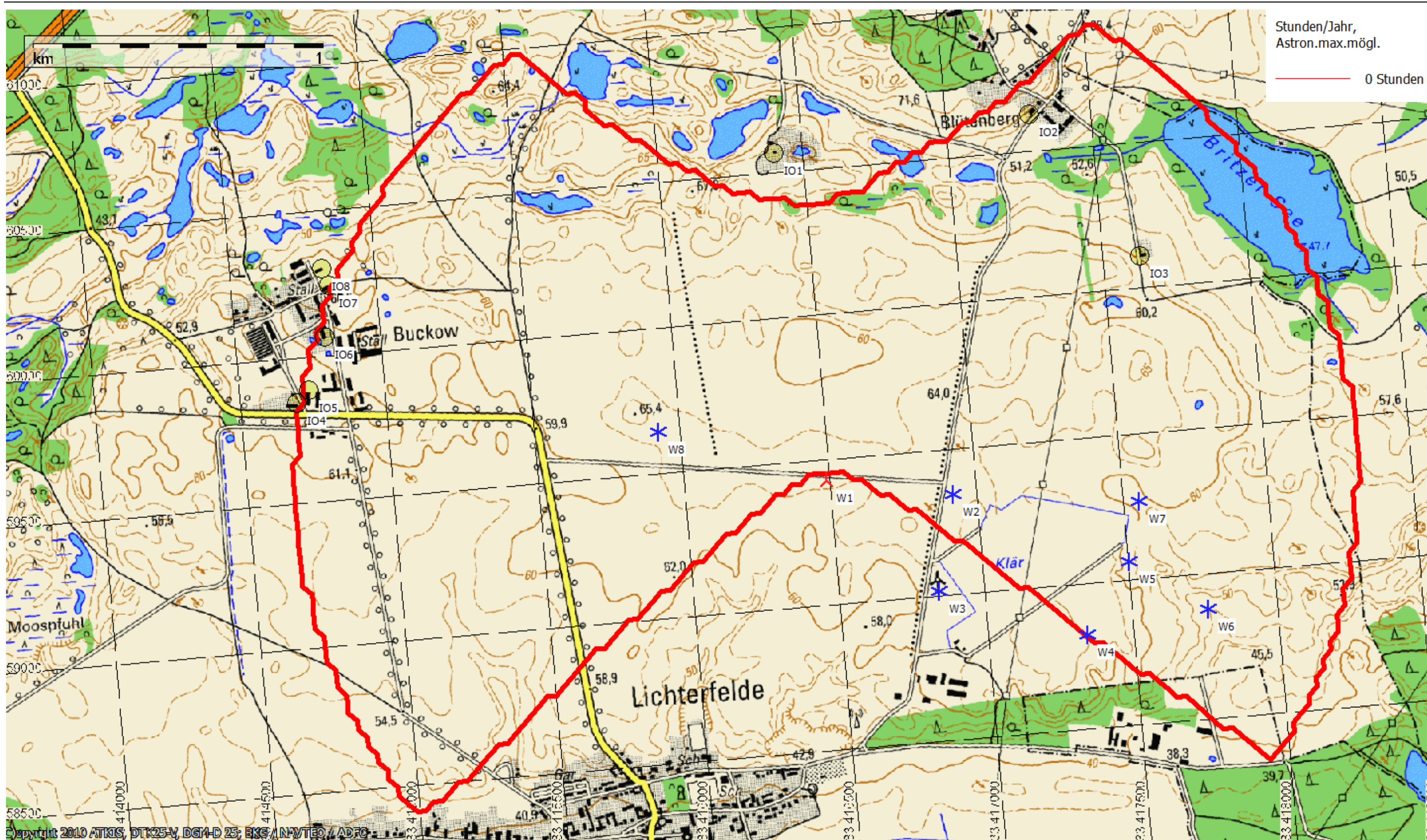
Abbildung 5.1: Einwirkungsbereich der neu geplanten WEA und Lage der Schattenrezeptoren
