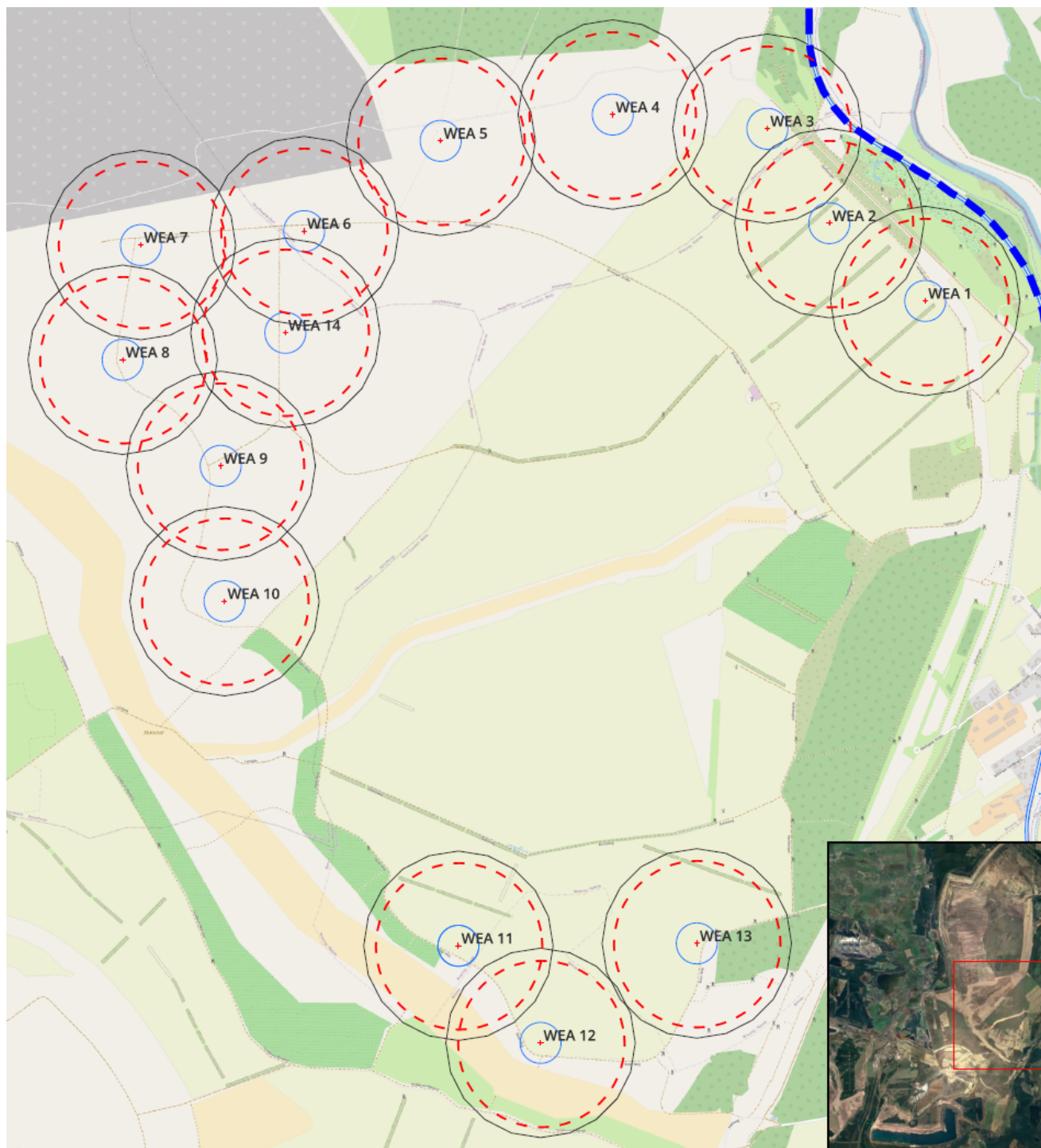
Abbildung 2: Gefährdungsradius – rot gestrichelt ( v = 20,4 \text{ m/s} ).
